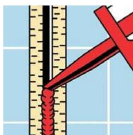
Depois da preparação adequada da junta e do substrato, introduza o delimitador na profundidade requerida.
