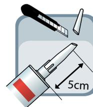
Remplir la traversée avec Soudal Aquaswell des deux côtés de l'élément en béton jusqu'à 5 cm de profondeur, selon le tableau ci-dessous.
