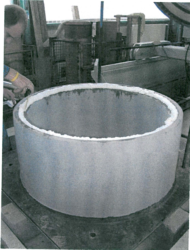
Bild 2: Fertigstellung der zweiten Lage des Schaumauftrages
