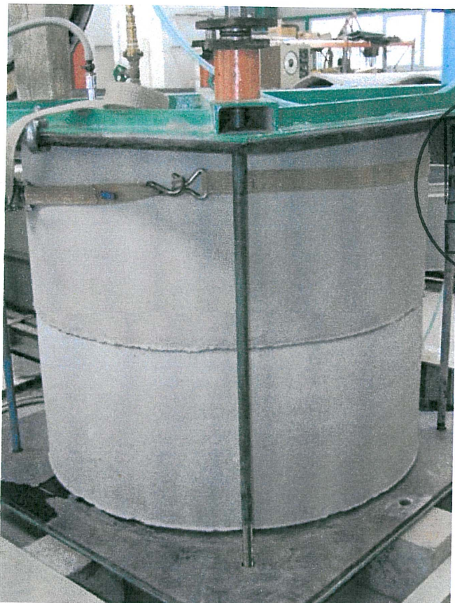
Bild 6: Ansicht der Schachtringe während der Druckprüfung bei 0,5 bar Wasserinnendruck, Verbindung blieb dicht
