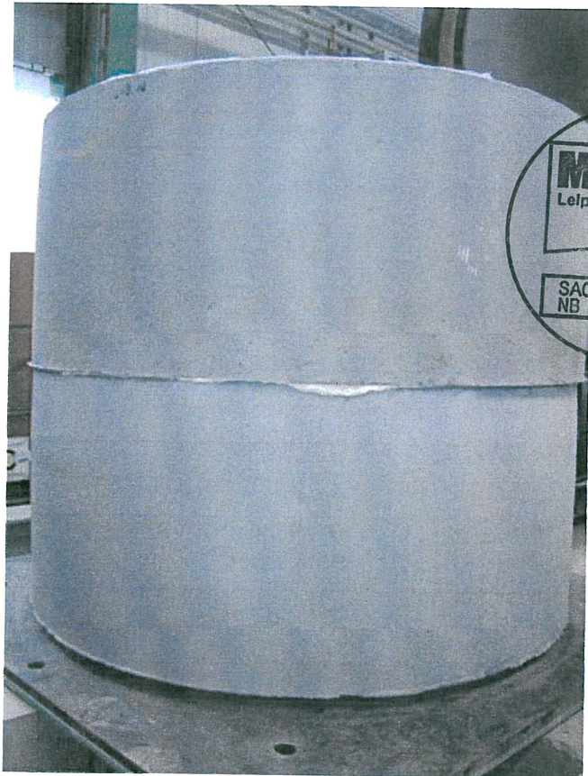
Bild 5: Ansicht der Schachtringe und der Verbindung von außen, wenig Schaum war ausgetreten
