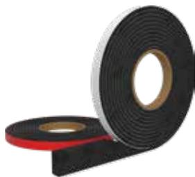
Soudaband PRO BG1 est une bande de mousse de polyuréthane précomprimée à cellules ouvertes, imprégnée d'un mélange stable de résines synthétiques qui lui confère les caractéristiques nécessaires d'étanchéité à l'air et à l'eau des joints de menuiserie et de façade.
