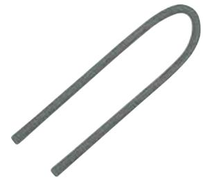
Le fond de joint PE est un profilé rond en mousse de polyéthylène à cellules fermées. Il est principalement utilisé pour remplir les interstices des joints de construction et d'expansion, afin d'assurer une dimension correcte pour l'application du mastic.
